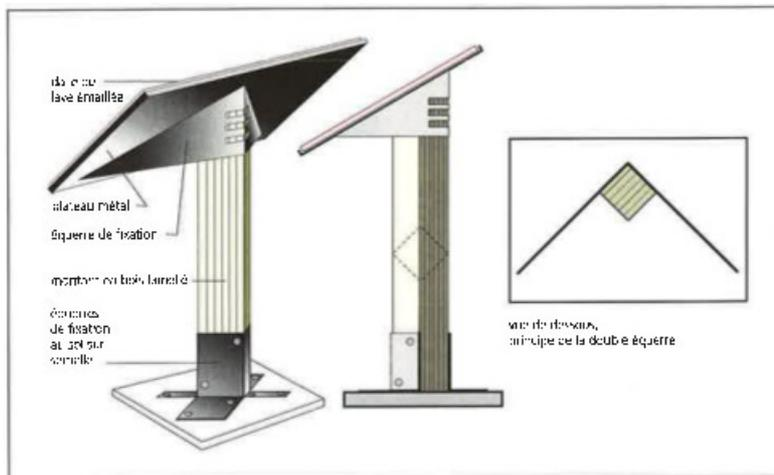
Mobilier-support. La liaison entre le plateau de métal qui supporte la dalle de lave se fait par l'intermédiaire d'une double équerre de métal soudée au plateau. Cette équerre donne également l'inclinaison du plateau - environ 30° au-dessus de l'horizontale - ce qui permet à la fois la lecture du texte et la vision du paysage.
